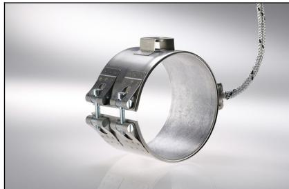
Ve srovnání s topnými pásy s keramickou izolací jsou levnější, méně výkonné a mají nižší pracovní teplotu. Lépe odolávají zatečení plastické hmoty. Mají menší teplotní setrvačnost.
