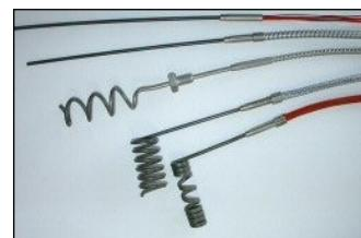
Typicky se přímé topné kabely používají pro svařovací lišty; stočené do cívek se používají pro *ohrev vstřikovacích trysek* při zpracování plastů. Při vyšších nározcích na výkon nebo homogenitu rozložení teplot mohou být zálogy v hliníku nebo v bronzu. Topné kabely **FC** s větším průřezem (např. 6,1 × 6,1) se používají pro ohřev lisovacích forem.
